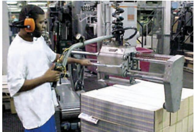
带有顶部旋转手柄控制的双气缸夹具
