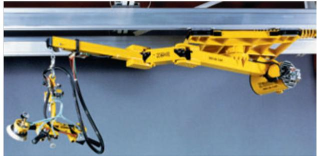
700系列机械臂结合了气动平衡吊的优点以及关节式机械臂的灵活性和伸展性。
