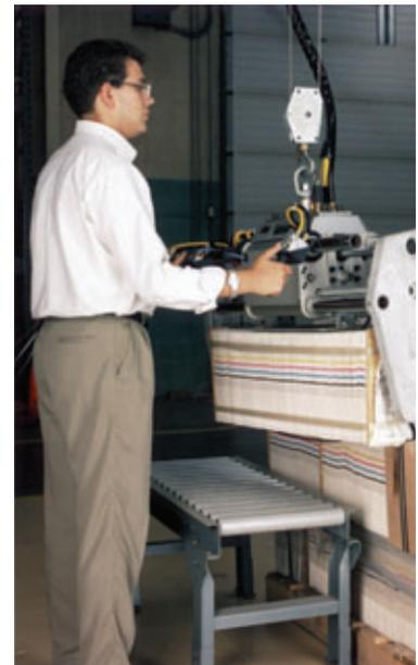
带有侧端控制的双气缸夹具
