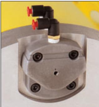
**Z止档：**可选的Z止档是一个专利装置，在停止运行或晚上气源被关闭时，防止悬挂负载或工具的向下漂移。Z止档可以在6英寸(152.4毫米)内停止负载漂移，将平衡空气置于机械锁定位置，防止对悬挂负载下方的工具或工件造成损坏。适用于所有10英寸(254毫米)筒身直径的装置。
