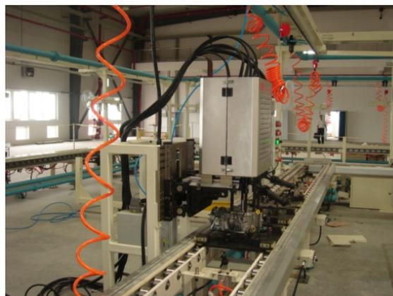
该设备为立式机架结构箱盖螺栓拧紧机。拧紧机构进给及返回通过气缸点动实现。安装于流水线侧面，手动操作完成箱盖螺栓的拧紧。
