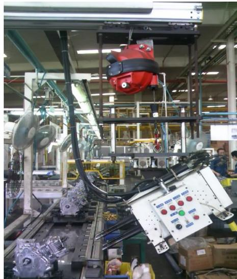
该设备为悬挂式缸盖螺栓拧紧机。拧紧机构进给及返回通过弹簧平衡器手动实现。
