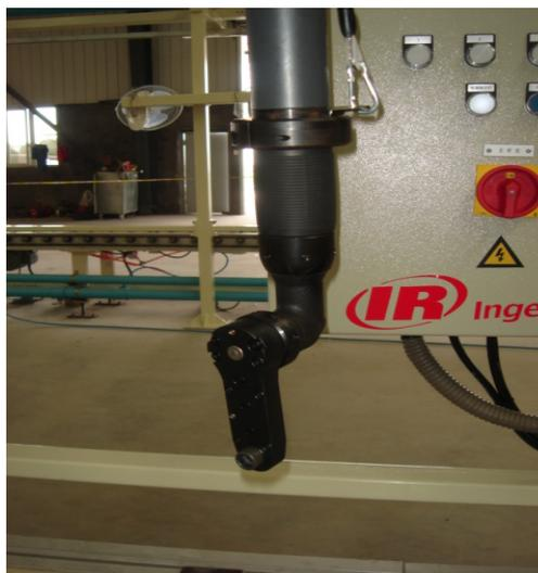
该设备为悬挂式缸盖螺栓拧紧机。拧紧机构进给及返回通过弹簧平衡器手动实现。
