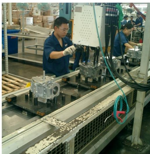
该设备为悬挂式箱盖螺栓拧紧机。拧紧机构进给及返回通过弹簧平衡器手动实现。
