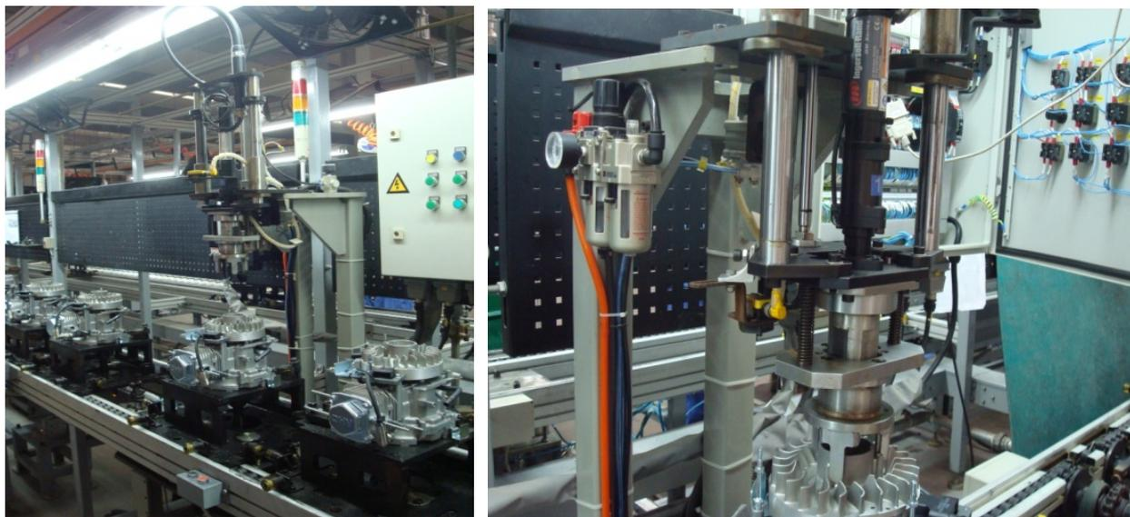
该设备为立式机架结构飞轮螺栓拧紧机。拧紧机构进给及返回通过气缸点动实现。前端具有防跟转机构。安装于流水线侧面。与流水线、托盘共同完成飞轮螺栓的拧紧。
