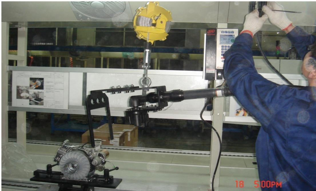
该设备为悬挂式飞轮螺栓拧紧机。拧紧枪升降通过弹簧平衡器手动实现。前端具有防跟转机构
