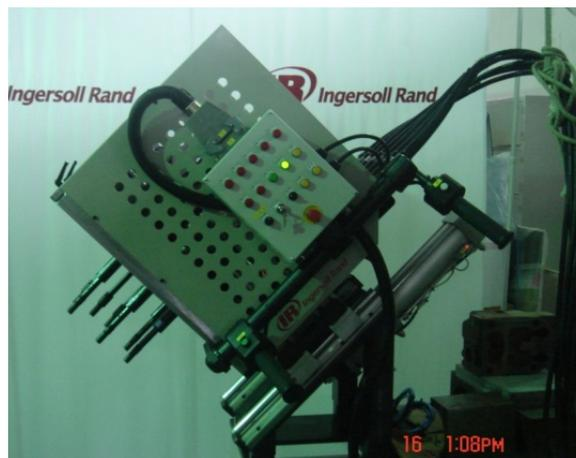
该类设备为工作台倾斜式箱盖螺栓拧紧机。进给及返回通过气缸点动实现。拧紧机采用7轴变6轴变距机构，变距模块通过气缸驱动。
